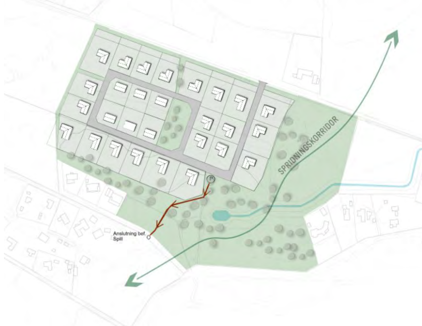
Figur 20: Förslag på anslutningspunkter och placering av pumpstationer.
