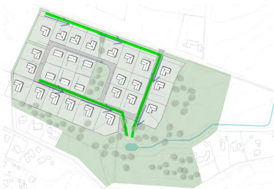
Avledning och fördröjning av dagvatten inom planområdet. Gröna linjer visar diken eller ledningar. Blå pilar visar flödesriktningar inom planområdet.
