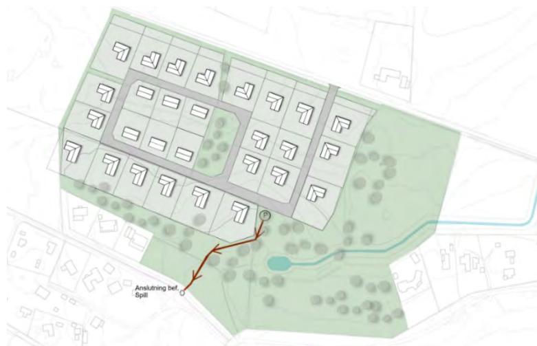
Förslag på anslutningspunkt och placering av pumpstation.
