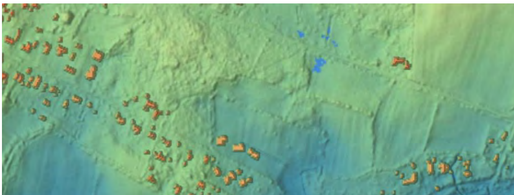
Figur 5: Skyfallsanalys 100årsregn med 48 mm, inklusive avdrag från ledningsnät.
