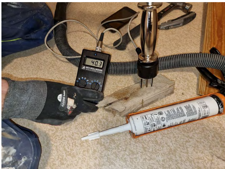
Figur 33 Fuktkvot spikregel P7
