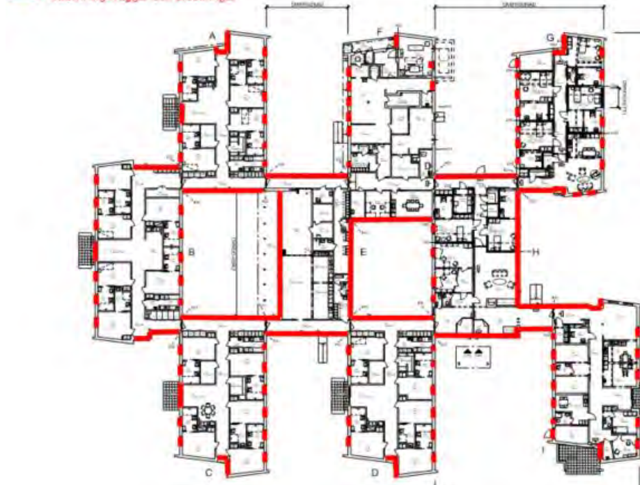
Figur 5 Utfackningsväggar och träbröstningar markerade
