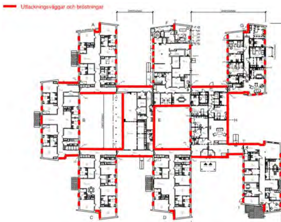
Figur 3 Utfackningsväggar och träbröstningar markerade.
