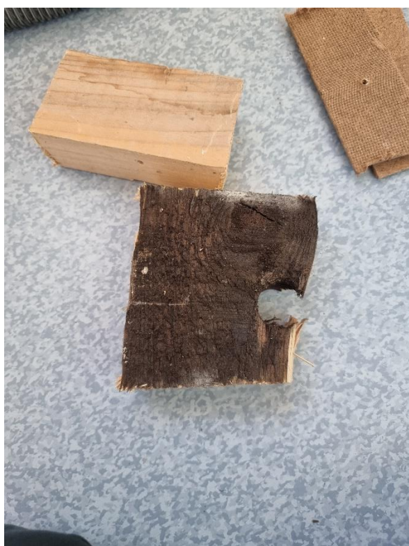
Figur 50 svart undersida syll, tjärdoft
