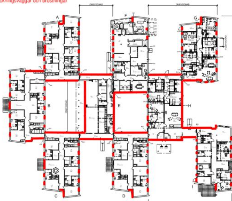
Figur 5 Utfackningsväggar och träbröstningar markerade
