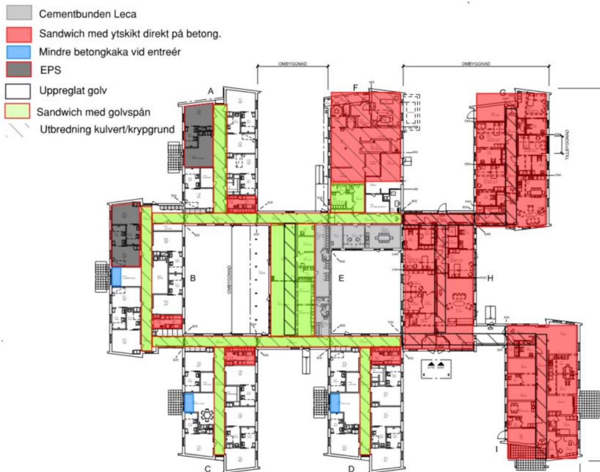
Figur 2 Golvkonstruktioner och dess utbredning
