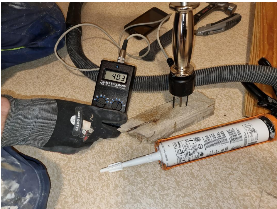
Figur 33 Fuktkvot spikregel P7
