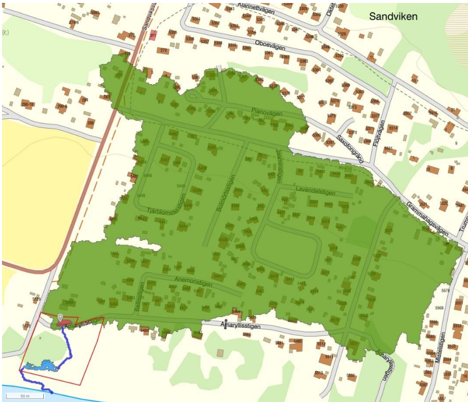
Figur 8. Avrinningsområde som avrinner genom utredningsområdet vid stora regn markerat i grönt. flödesväg genom utredningsområdet visas som blå linje. plangränsen visas som röd linje.
