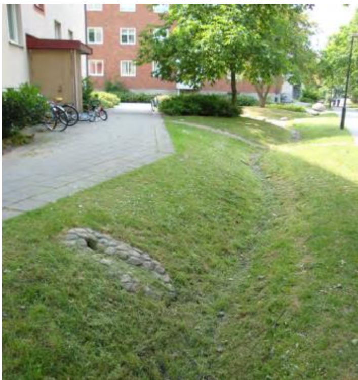
Figur 9: Exempel på Svackdike. Källa: RG dagvattenhandbok.
