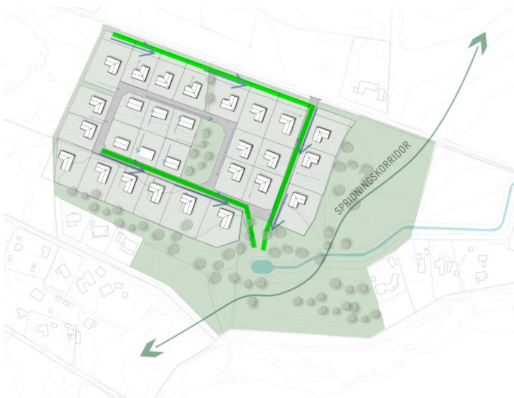
Figur 6: Höjdsättningsprinciper av marken. Gröna linjer visar diken. Blå pilar visar flödesriktningar inom planområdet.
