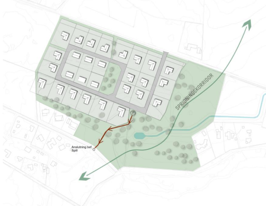
Figur 20: Förslag på anslutningspunkter och placering av pumpstationer.
