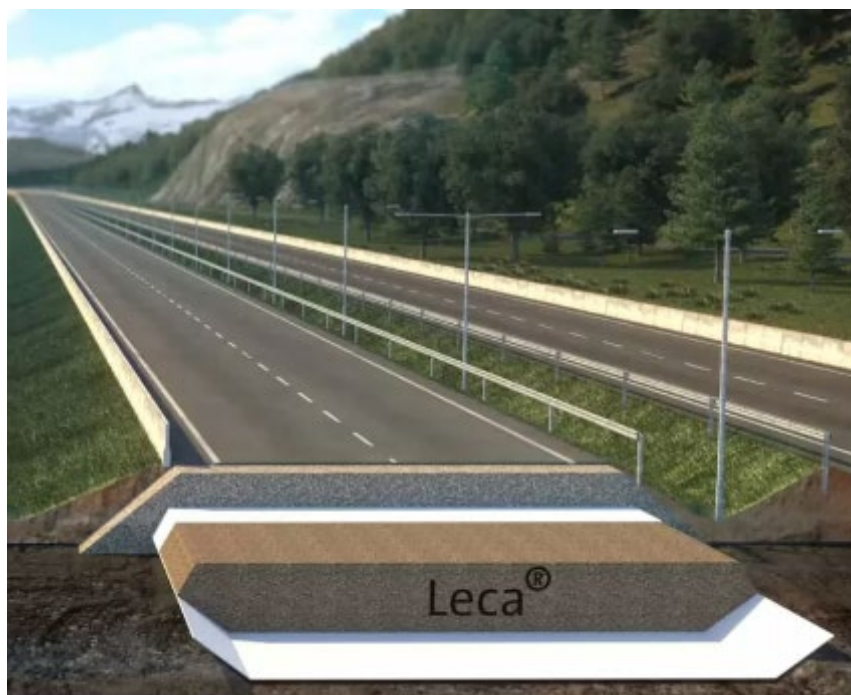
Byggnation av vägkropp med lättfyllnad, bild 4
