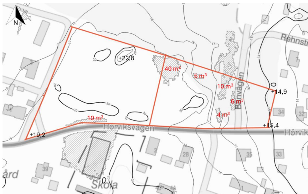
Figur 4. Planområdet (röd linje) med befintliga markhöjder i svart text. Räfflade ytor visar befintliga lågpunkter där röd text visar fördröjningskapaciteten. Markhöjder avlästa från Lantmäteriets laserskannade höjddata, tillgänglig i Scalgo Live lågpunktskartering (2025).
