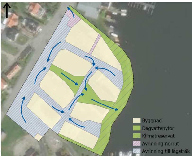
Figur 7. Princip för avledning av skyfallsvatten. Blå pilar markerar avrinningsriktning.
