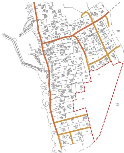
Karta över gatunätet på Hanö, röd linje är asfalterad gata, orange linjer är gräsgator. Planområdet illustreras med streckad röd linje.
